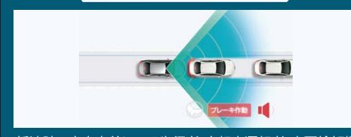
低速時の自車直前にいる歩行者、自転車運転者、車両検知機能により衝突回避・被害軽減をサポート
