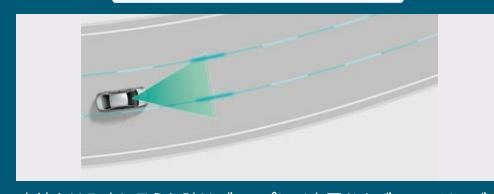
車線をはみ出しそうな時はディスプレイ表示およびステアリングの振動または警報ブザーにより警告。ステアリング操作も支援します
