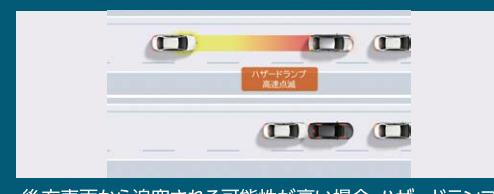
後方車両から追突される可能性が高い場合、ハザードランプを高速点滅させて後方車両に注意喚起します。
