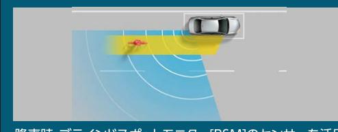
降車時、ブラインドスポットモニター[BSM]のセンサーを活用し、後方からの自転車を含む接近車両などを検知。
