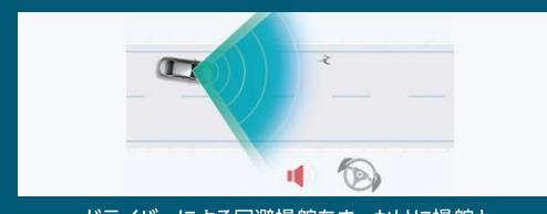
ドライバーによる回避操舵をきっかけに操舵と車線逸脱抑制をサポート。
